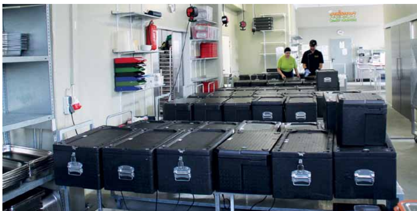
Die GN-Behälter mit den individuell portionierten Speisen werden mit einer Heizplatte in den Thermoboxen zur Kindereinrichtung transportiert.
